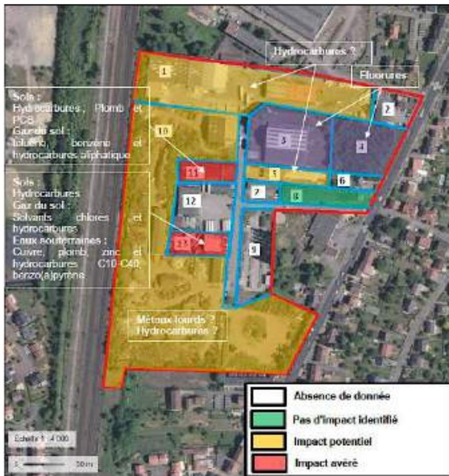
Figure 4 : Synthèse des pollutions potentielles réalisée par Artélia en 2018 sur la ZIL Nord, partie nord de la zone n°10
